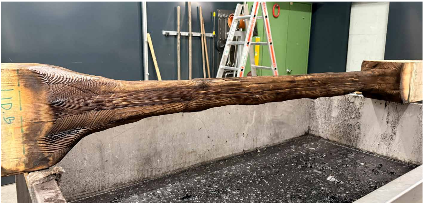
QUERSCHNITT 240×240 MM 2 , FICHTEN-BSH, ZUGBELASTUNG MIT 360 KN, NACH 90 MINUTEN VIERSEITIGEM ABBRAND IM BRANDOFEN DER ETH ZÜRICH UND DEM ENTFERNEN DER HOLZKOHLE. • CROSS-SECTION 240×240 MM 2 , SPRUCE GLULAM, SUBJECTED TO A TENSILE LOAD OF 360 KN, AFTER 90 MINUTES OF FOUR-SIDED CHARRING IN THE FIRE FURNACE AT ETH ZÜRICH AND SUBSEQUENT REMOVAL OF THE CHARCOAL. • © ANDRES OLLINO
