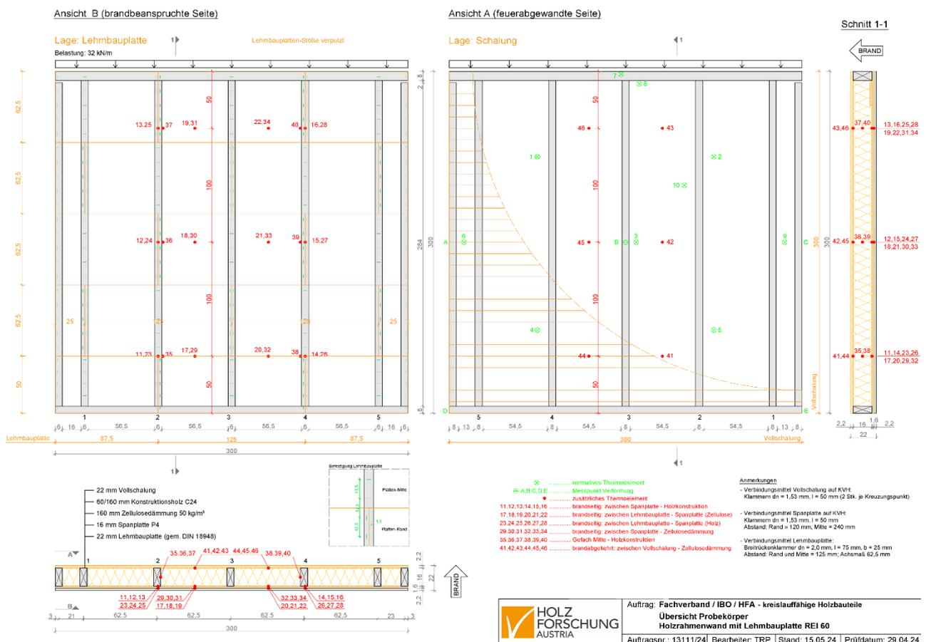
Abbildung 1: Konstruktionszeichnung der Holzrahmenwand
