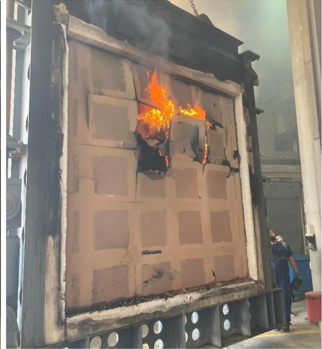
Abbildung 2: Holzrahmenwand, feuerabgewandte Seite nach 68 Minuten
