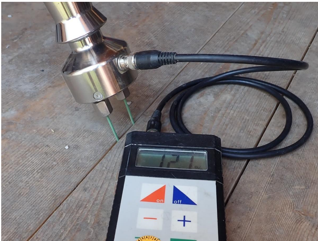
Abbildung 2: Holzfeuchtemessung mit isolierten Elektroden (Messung des elektrischen Widerstandes)
