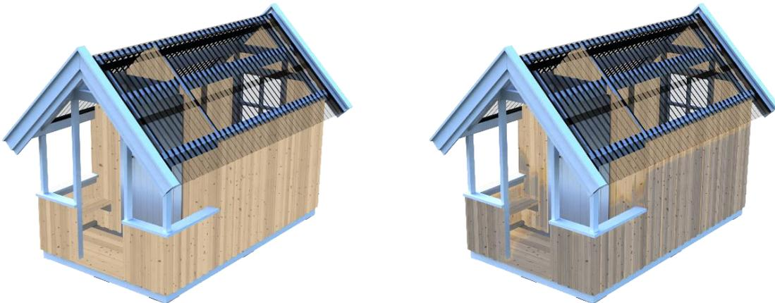
Abbildung 3: Simulation der ästhetischen Veränderung von Holzgebäuden. Links: Holzgebäude im unbewitterten Zustand; Rechts: Holzgebäude nach einem Jahr simulierter Bewitterung
