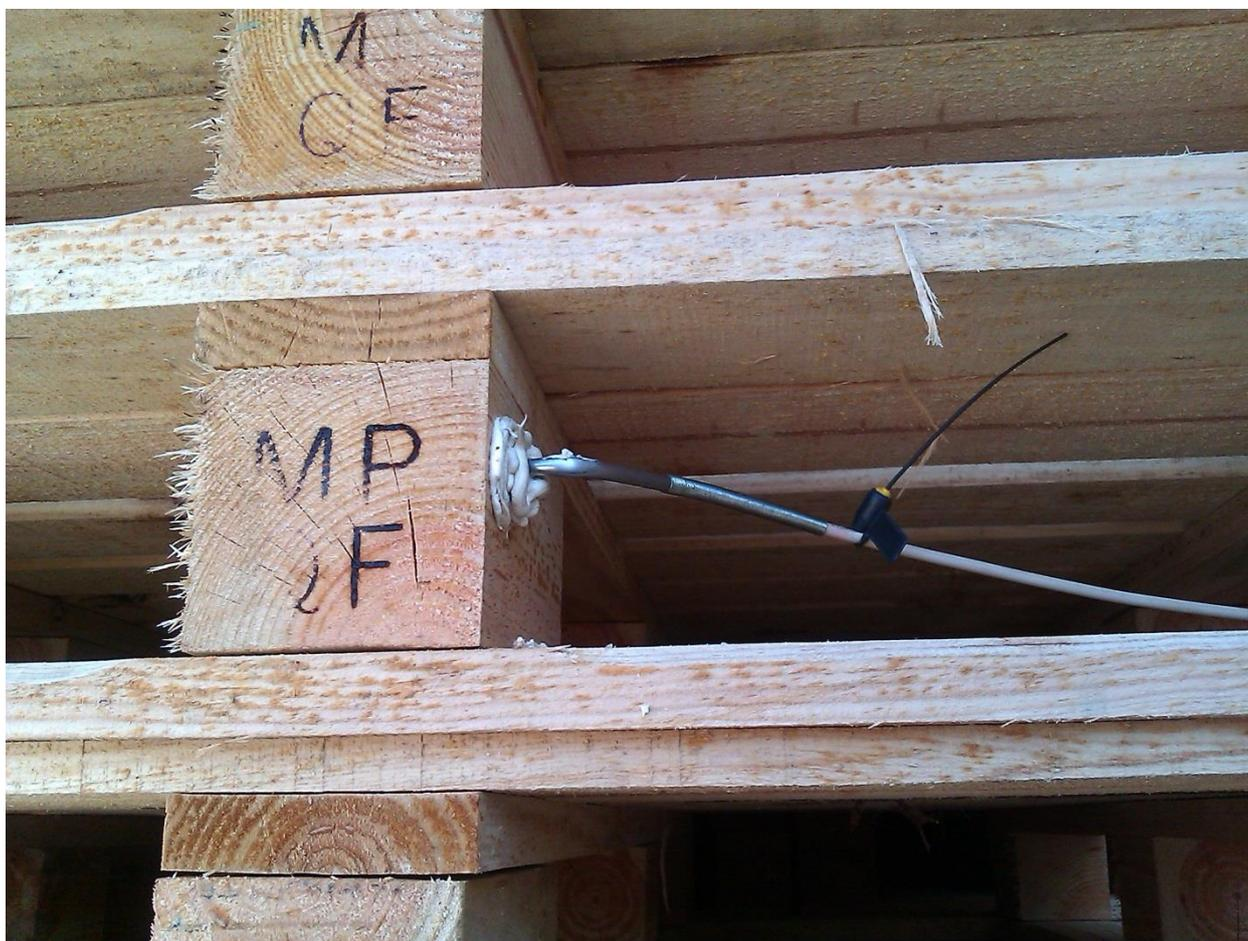
Abbildung 2: Beim Beladen einer Hitzekammer ist auf ausreichende Luftzirkulationen bei allen Holzstapeln zu achten. Die Kammer sollte daher vollständig gefüllt werden und die einzelnen Holzstücke sollten in einem Abstand von mindestens 15 mm übereinander gestapelt werden.
