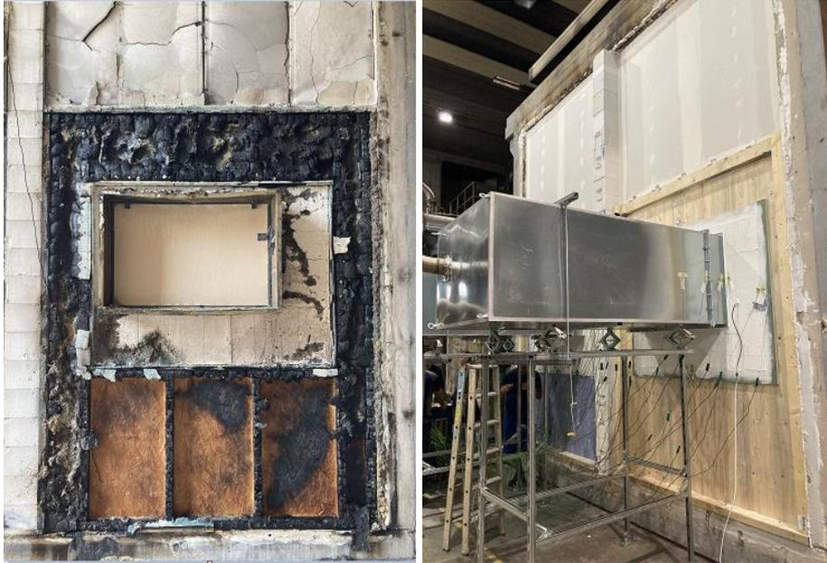
Abbildung 7: Brandversuche mit unterschiedlichen Einbau Situationen in Holzrahmen-/Holzmassivbauweise und Brandschutzklappen, Bilder Holzforschung Austria
