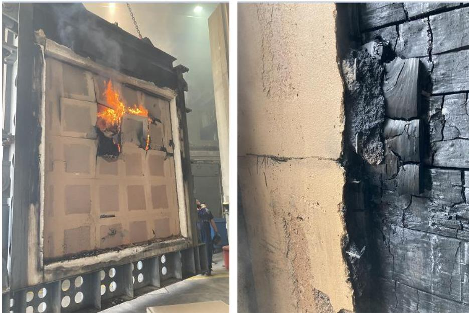
Abbildung 8: Brandversuche mit Lehm- bauplatten in Holzrahmen- / Holzmassivbauweise, Bilder Holzforschung Austria
